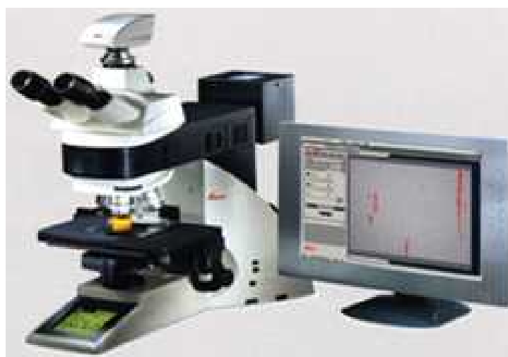
図 2-1 鋼介在物自動解析システム
